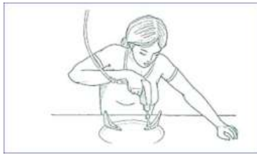
Figura 14: Exemplo de posição forçada de trabalho em razão da ferramenta adotada e da posição do plano de trabalho
